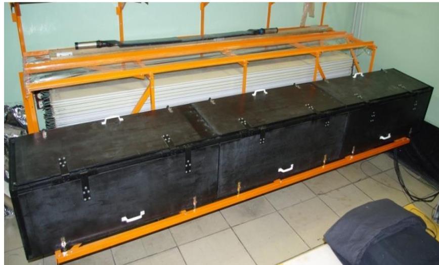
Общий вид стенда. 1 – стеллаж; 2 – корпус стенда с открытыми крышками; 3 – рама для стрипов.
